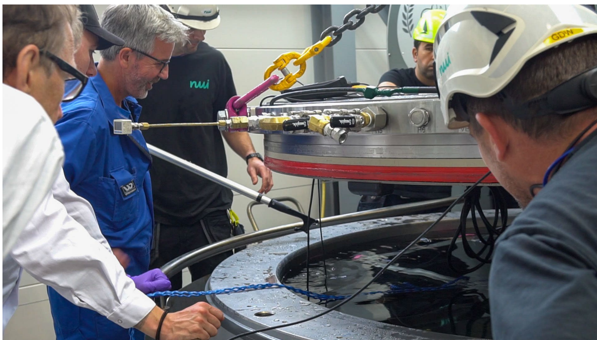
Figur 7: Fisken ble testet i trykktank som kunne utsette den for både over- og undertrykk. Foto: Jonas Giæver/NIVA.
